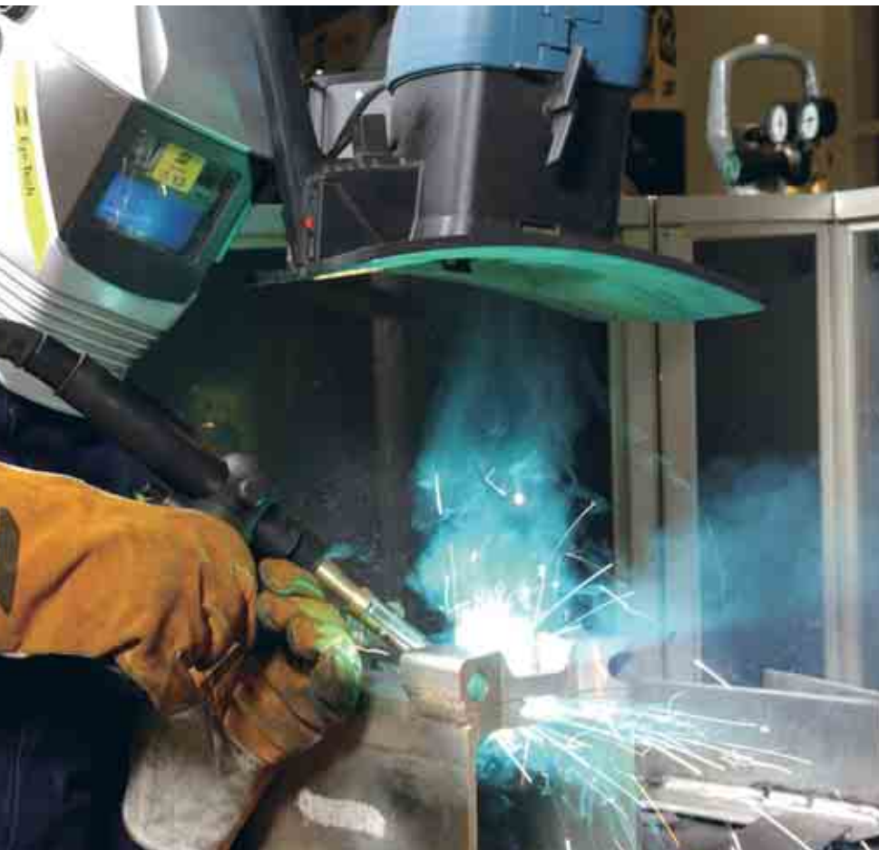
Hitsaustyölle on tyypillistä altistuminen hitsaussavuille, joilta hitsaajan pitää suojautua tehokkaasti.
