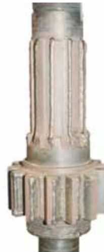
Raskaan ajoneuvon kuluneen vetoakselin korjaus.
