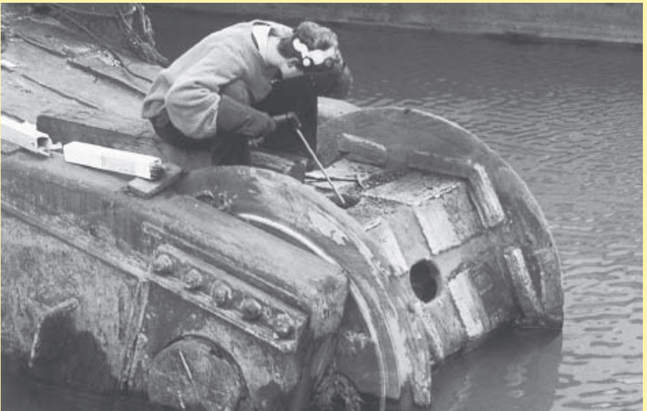
Ruoppajaan taittopyörän kovahitsaus: OK 84.84. Täyttöhitsaus OK 83.28.
