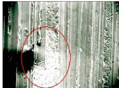
Rakokorroosio hiomatta jääneessä kohdassa. Erikoishaponkestävän teräksen 254 SMO pinta, joka on hiottu karkeudella 120.
